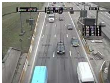
Εικόνα 9.6: Εικόνα λειτουργίας συστήματος ψηφιακής επεξεργασίας εικόνας. Διακρίνονται οι γραμμές ανίχνευσης.
