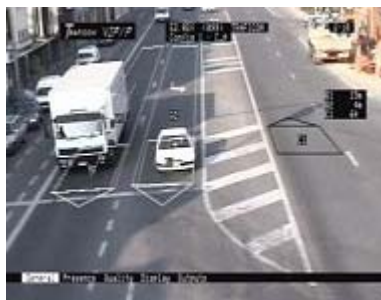
Εικόνα 9.10: Ανίχνευση αναμένοντων οχημάτων σε σηματοδότη.
