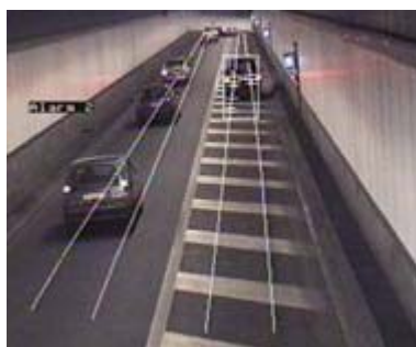
Εικόνα 9.9: Ανίχνευση σταματημένου οχήματος σε σήραγγα.
