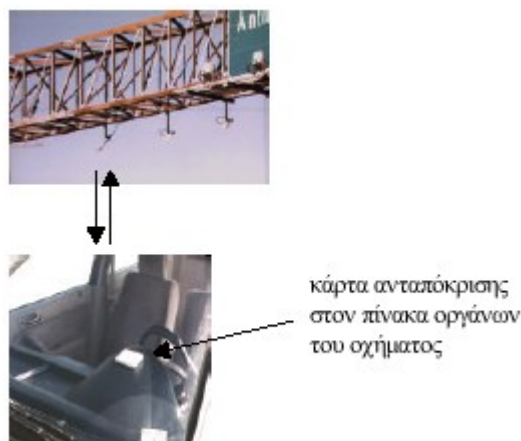
Εικόνα 9.12: Λειτουργία συστήματος παρακολούθησης με κάρτες ανταπόκρισης οχημάτων.
