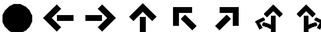
Εικόνα 5.1: Τυπικές μορφές φωτεινών σημάτων απευθυνόμενων σε οχήματα (κυκλικής μορφής και βέλη πορείας).
