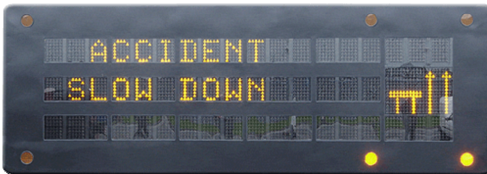
Εικόνα 4.3: Πινακίδα Μεταβλητών Μηνυμάτων με διόδους LED.
