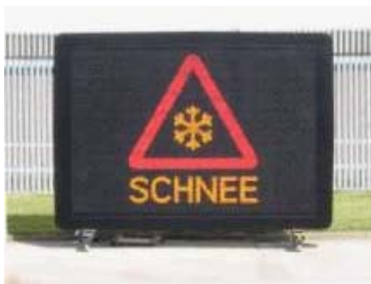
Εικόνα 4.5: Εφαρμογή του συστήματος dual colour LED.
